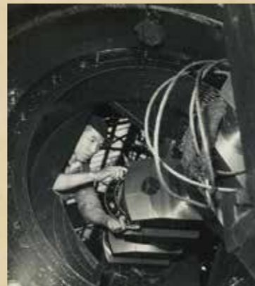
クランク軸ピン径計測作業 旧神戸工場 機械工場 昭和20年代後半
