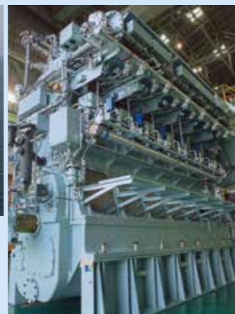
LH41LAE形電子制御機関 3600馬力
