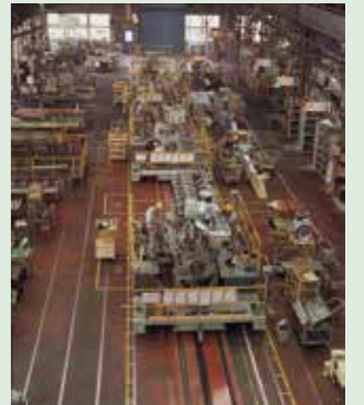
ライン化された小型エンジン組立ライン
