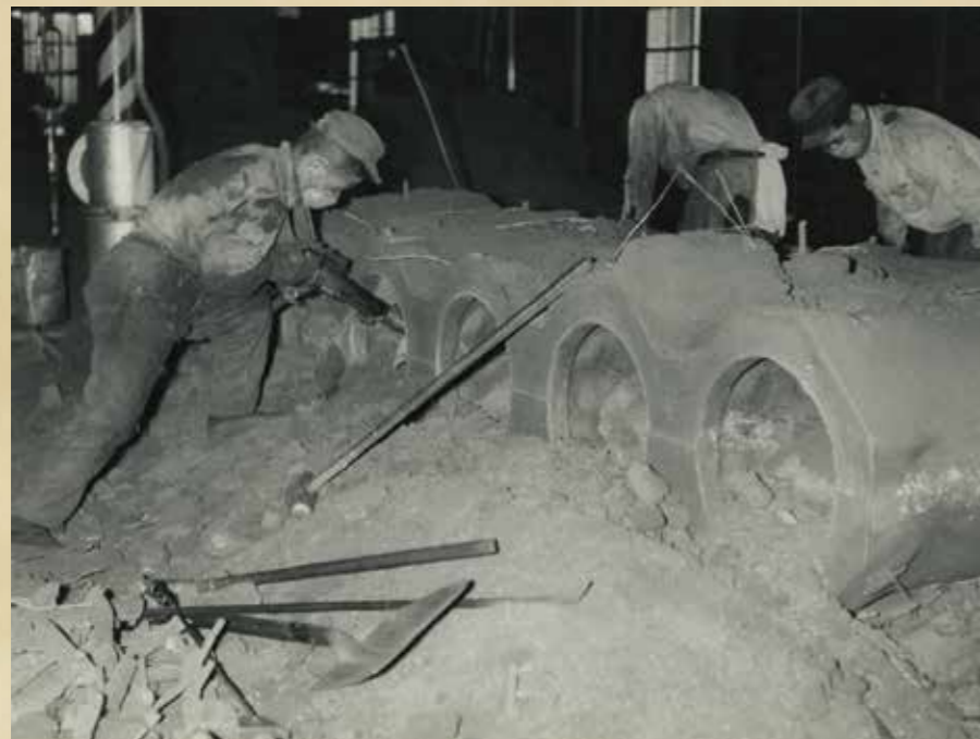
型バラシ作業 旧神戸本社工場 鑄造工場 昭和20年代
