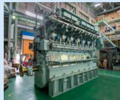
LH46LAE形電子制御機関 4500馬力
