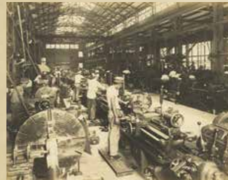
連接棒機械加工 旧神戸本社工場 機械工場 1937(昭和12)年頃
