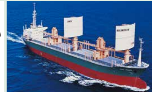
外航帆装船第一船の田中産業のウスキパイオニア号 6EL40形2基1軸搭載
