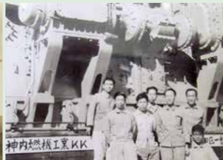
出荷を待つ2サイクルR7E型機関 左の写真と比較するとエンジンの大きさが分かる
