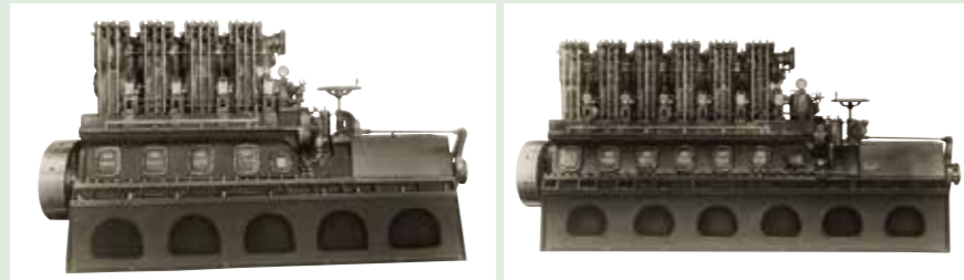
鳥取県庁「だいせん」向け4EP型 180馬力 日魯漁業向け 6EP型 270馬力
