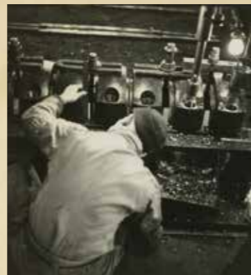
主軸受冠穴明け加工 旧神戸工場 機械工場 昭和20年代後半
