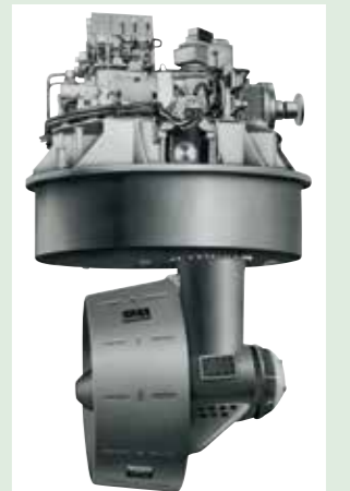
内海曳船の疋田丸に搭載されたH3形ジャイロ可変ペラ
