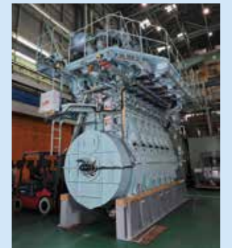
6S30ME-B9.5形電子制御機関 3840kW
