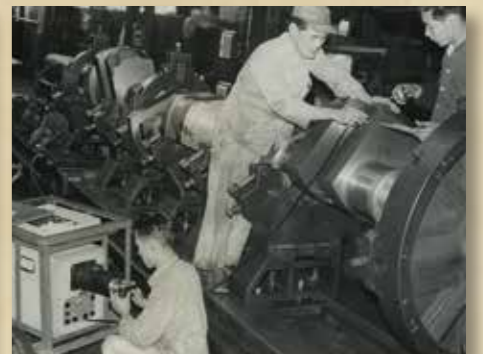
クランク軸機械加工 旧神戸本社工場 機械工場 昭和30年代前半
