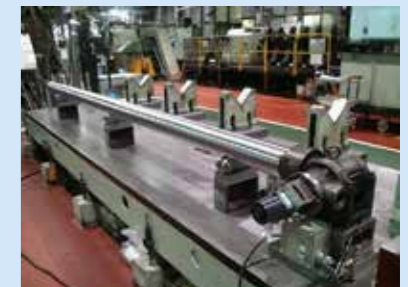
Dグループ製作の改善道具 2サイクルカム軸ケガキ装置
